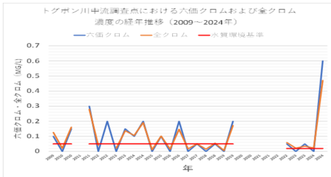
図：トグボン川中流調査点における六価クロムおよび全クロム濃度の経年推移（添付報告書より抜粋）
