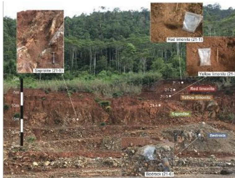
図10 スラウェシ島 USSU 鉱山 Ni ラテライト鉱脈の断面 9)
