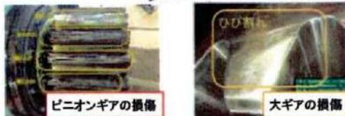
図2 カッターモーターの損傷状況
