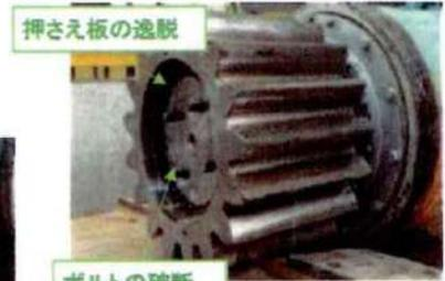
写真2 ピニオンギア(故障後)
