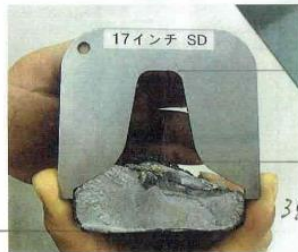
回収したディスクカッター部材片とゲージとの照合
