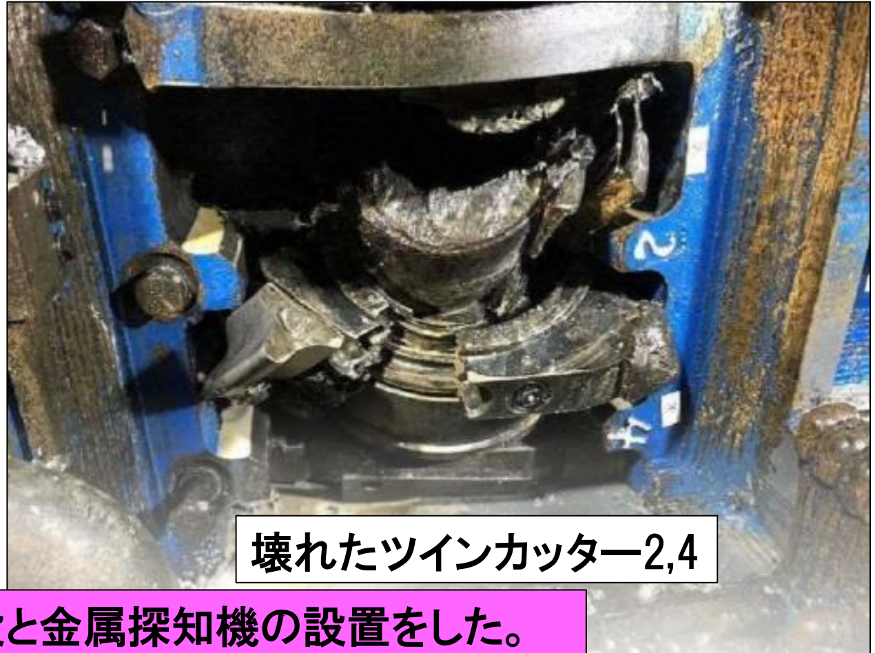
壊れた17インチのディスクカッター
