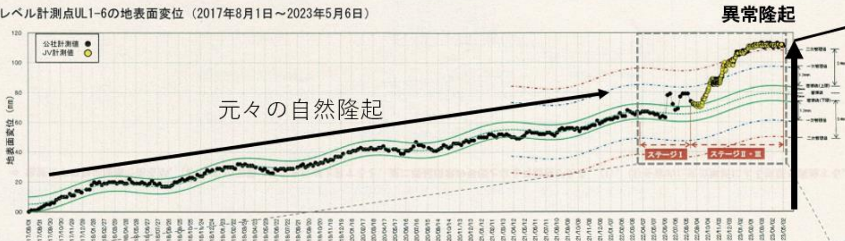
計測点と切羽との位置関係および施工状況との比較（2022年4月1日～2023年5月6日）
