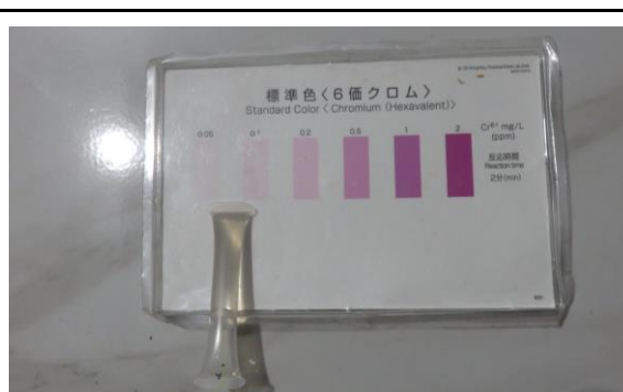
アスリ村のコミュニティが利用している水の六価クロム簡易検知管による検査結果（0.05 mg/L）（写真：2022年10月23日）
