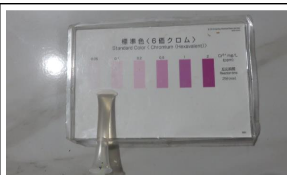
アスリ村のコミュニティが利用している水の六価クロム簡易検知管による検査結果（0.05 mg/L）（写真：2022年10月23日）
